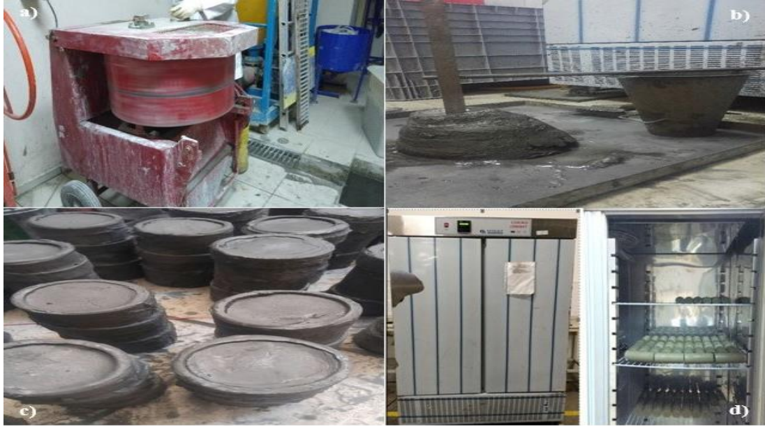
Şekil 5. Çimentolu macun dolgu numunelerinin hazırlanma aşamaları [16]
