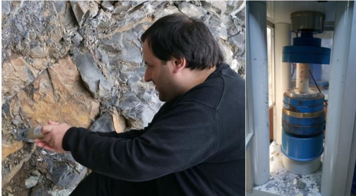
Şekil 4. Schmidt çekici geri tepme değeri ölçümü b) tek eksenli basınç dayanım deneyi
