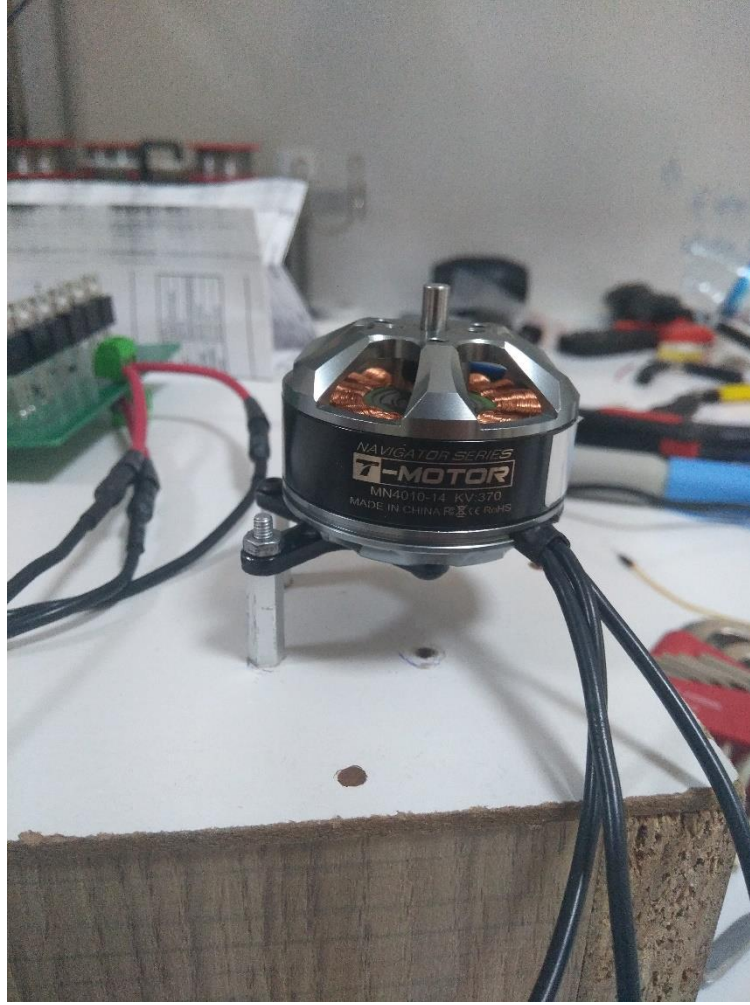
Şekil 5.1.4. Test amaçlı kullanılan BLDC motor
