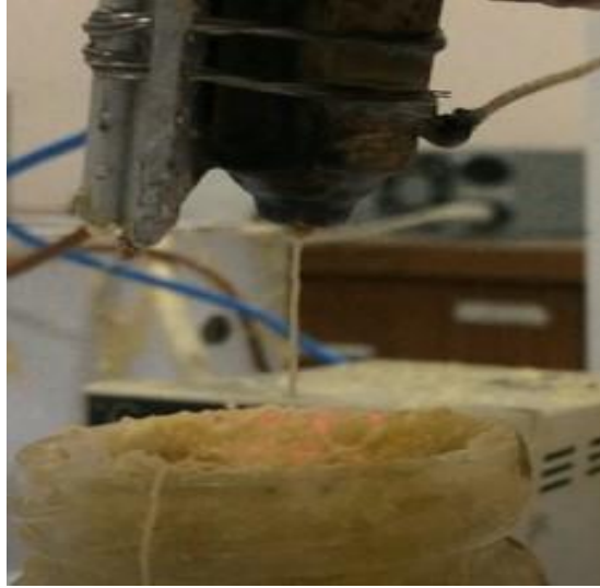
Şekil Hata! Belgede belirtilen stilde metne rastlanmadı.. 9. Deney no:15 Mum akışı kıvama yakın
