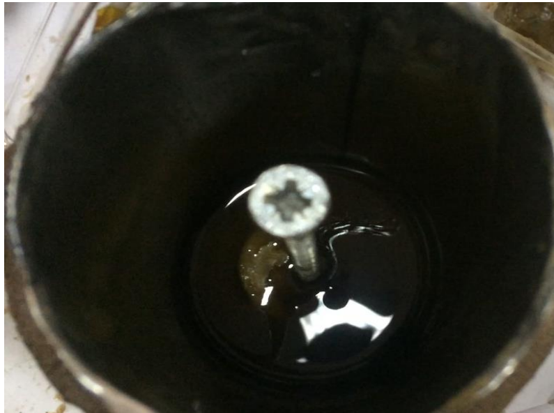
Şekil Hata! Belgede belirtilen stilde metne rastlanmadı..13. Mum sızıntısı
