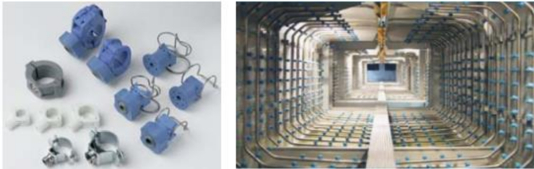
Şekil 5.21. Yüzey İşlem Nozulları Ve Aksesuarları
