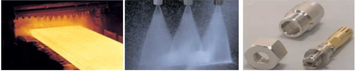
Şekil 5.19. Çelik Sanayi Nozulları - Tufal Kaldırma
