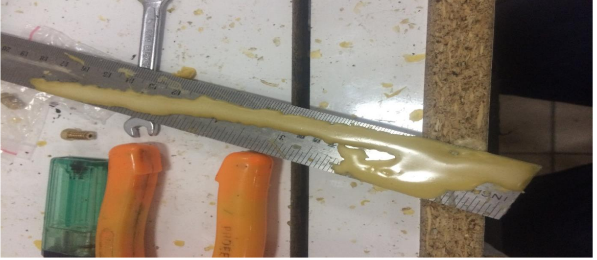
Şekil Hata! Belgede belirtilen stilde metne rastlanmadı.. 5. Deney no:3 istenen hamursu kıvam yerine sıvı akışı elde edilmiştir.
