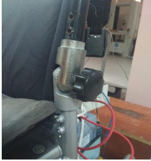
Şekil 2-24. Araç koltuğunun sırt bölümünü ayarlama kısmı
