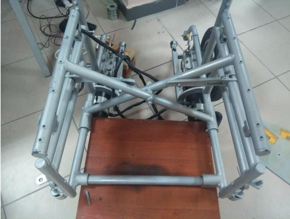
Şekil 2.21 Aracın katlanabilmesini sağlayan mekanizma
