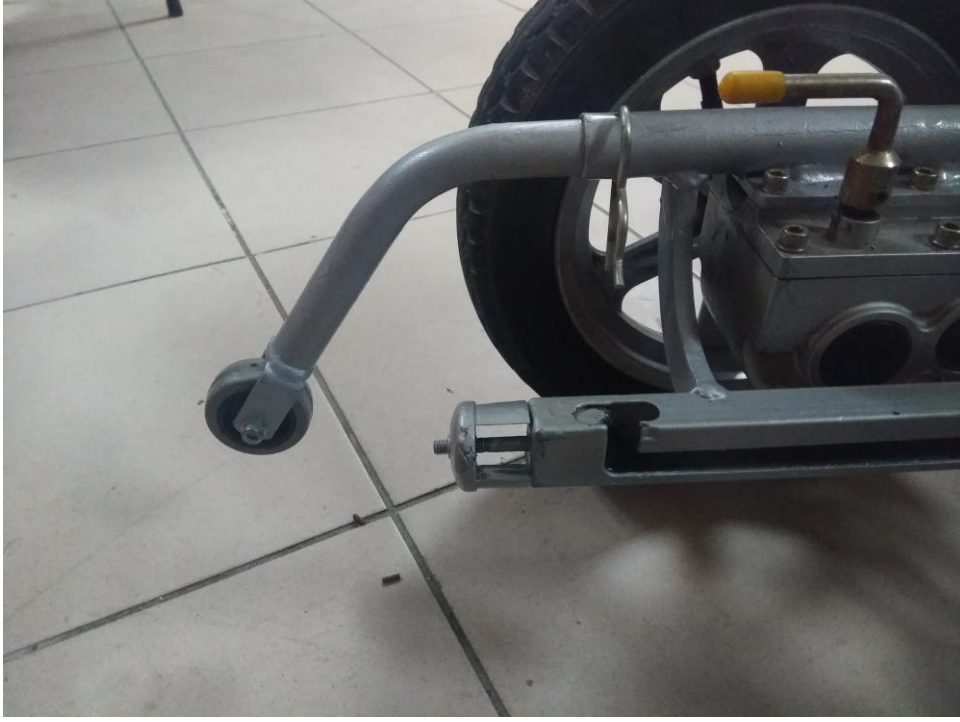
Şekil 2.22 Aracın arka kısmında konumlandırılan destek tekerleri
