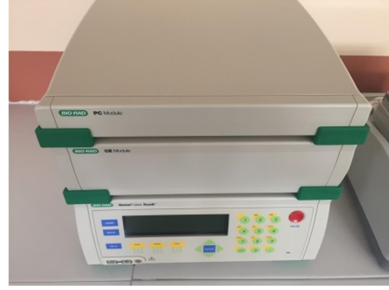
Gene Pulser Xcell™ Modüler elektroporasyon sistemidir. Birincil ve kök hücrelerden bakteri ve mayalara nükleik asit aktarımı yapmaya olanak verir.
