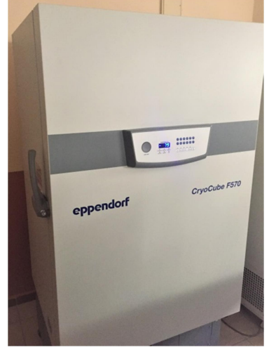
Wise Cryo ve CryoCube F570 -80 derecede ileride gerçekleştirilecek çalışmalar için elde edilen örneklerin uzun süre bozulmadan korunmasını sağlar.
