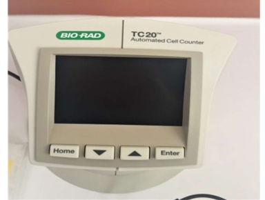
BIO-RAD TC20™ Hücre hattı, doku, kan ve kök hücreler gibi geniş aralıkta hücre tipi ve boyutuna sahip örneklerde 30 saniye gibi kısa sürede hücre sayımı gerçekleştirebilir.
