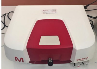
Guava® easyCyte Çoklu parametrelerin tespit yeteneği sayesinde floresan reaktifleri kullanarak daha geniş spektral seçim sağlamanın yanı sıra, birden fazla floresan özellikteki proteinin aynı anda tespitini yapar.
