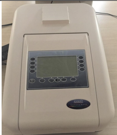
Genova Nano-Jenway DNA, RNA ve Protein konsantrasyon ve saflık ölçümlerinde kullanılır
