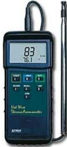
Fotoğraf 3.1 Kule giriş kesitinde gazın hızını ve sıcaklığını ölçebilen multimetre
