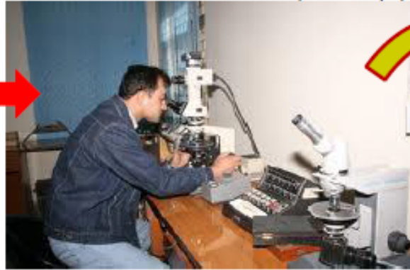
Kayaç örneğinden hazırlanmış ince kesitin mikroskopta incelenmesi
