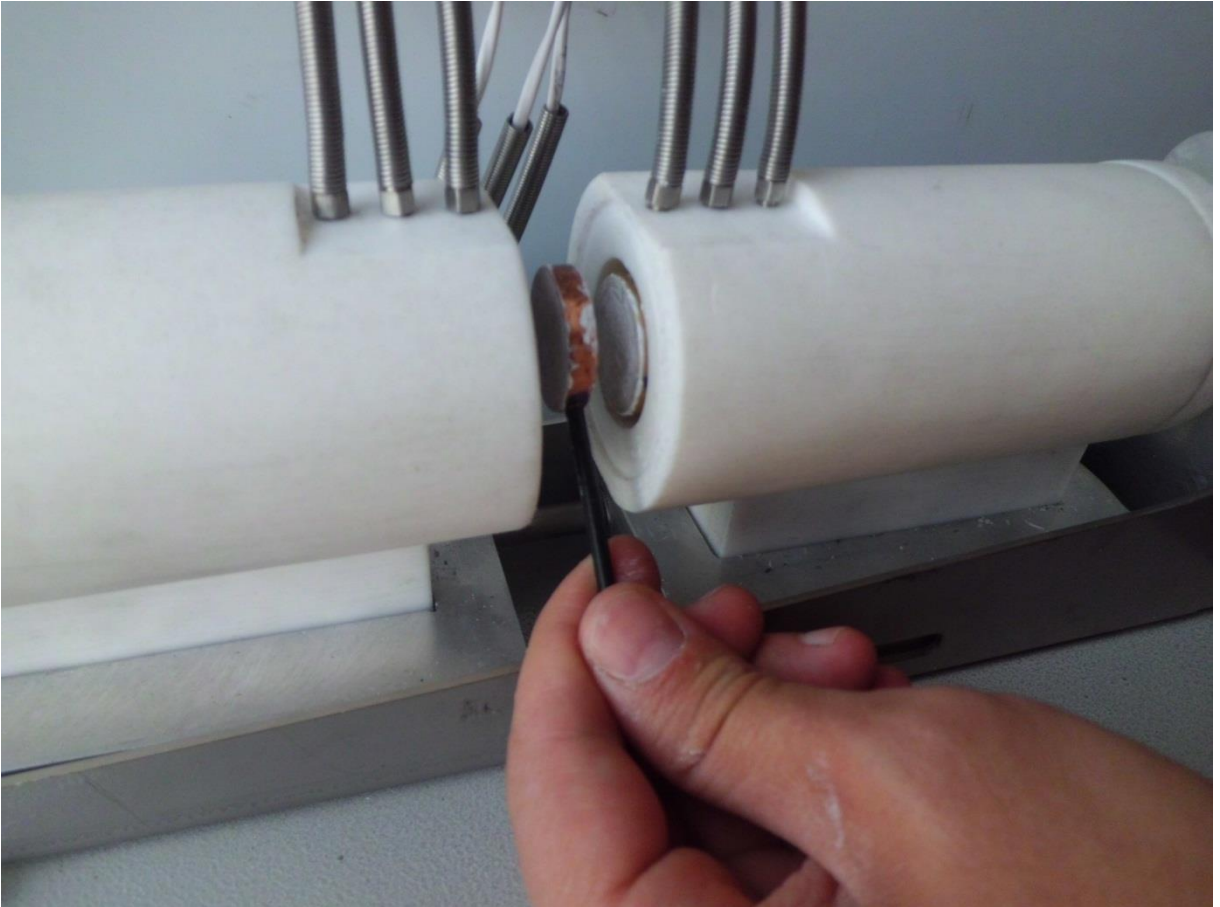
Şekil-6 Bronz malzemenin yerleştirilmesi
