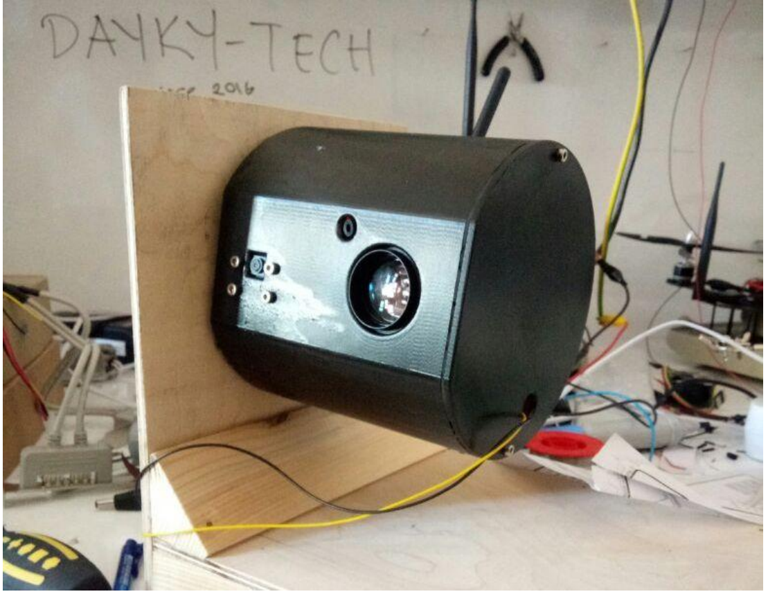
Şekil 5.8. Hedef Takibi Yapan Kamera Sistemi
