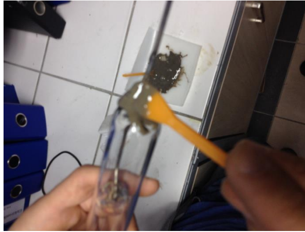
Şekil 3.21. Tüpe epoksi uygulama aşaması
