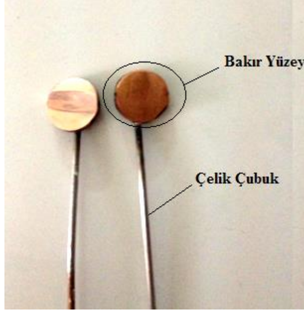
Şekil 3.9. Montajı yapılmış anot malzemesi
