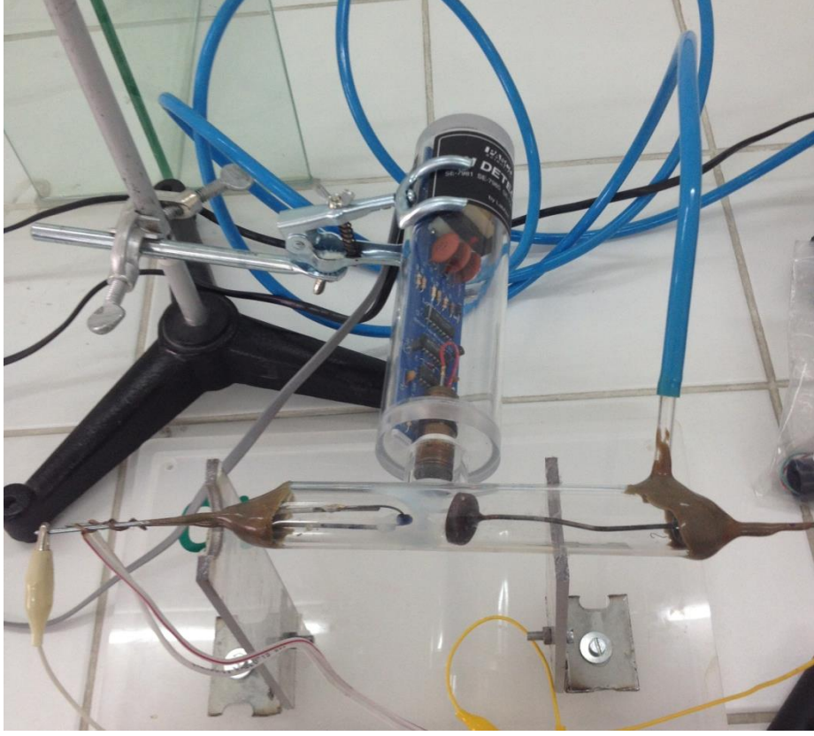
Şekil 5.2. Geiger-Müller sayacı ve X-ışını tüpü
