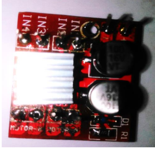
Şekil 3.10 MX1508 üzerinde soğutucu aparatı.
