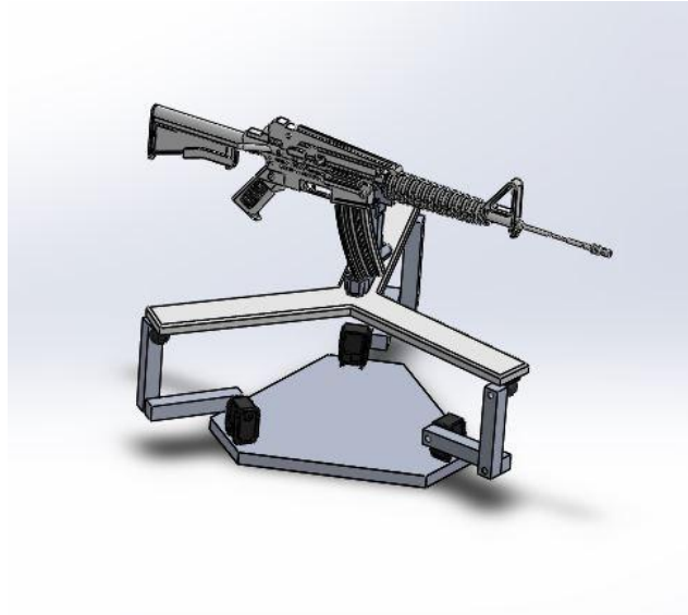
Şekil 7: Üst platformu yeniden tasarlanmış araca monteli stabilize silah sistemi.
