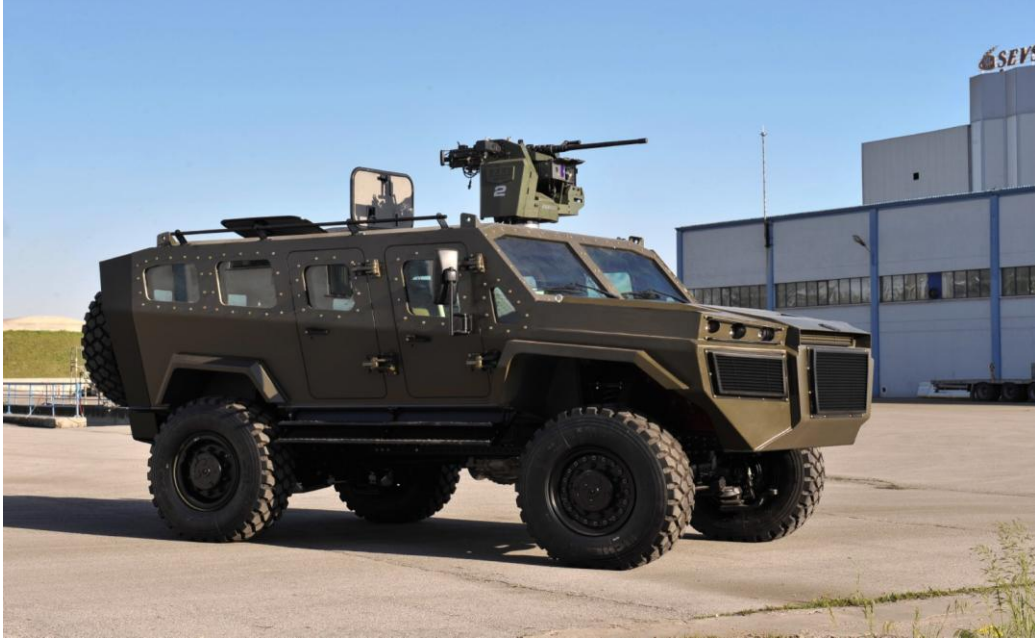
Şekil 1: SARP uzaktan komutalı stabilize silah sistemi.
