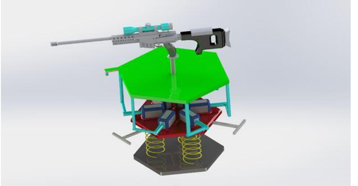
Şekil 4: İlk tasarlanan araca monteli stabilize silah sistemi.
