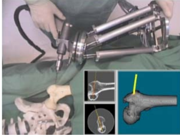
Şekil 1.6 Ortopedide kullanılan CRIGOS robotunun testi
